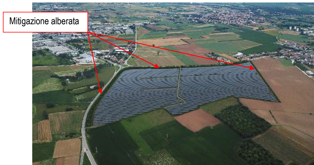
Figura 30: Fasce di mitigazione alberata a Ovest, Nord ed Est del nuovo impianto fotovoltaico
